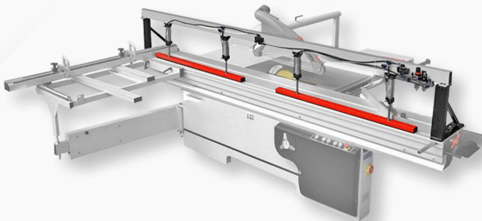
Pneumatska presa, pogodna za formatizere sa kliznim stolom dužine 3200 mm. Obezbeđuje sigurno fiksiranje radnog komada u području rezanja, eliminišući sve moguće probleme tokom sečenja. Ima dvodelni dizajn za obradu komada malih i velikih dimenzija.
