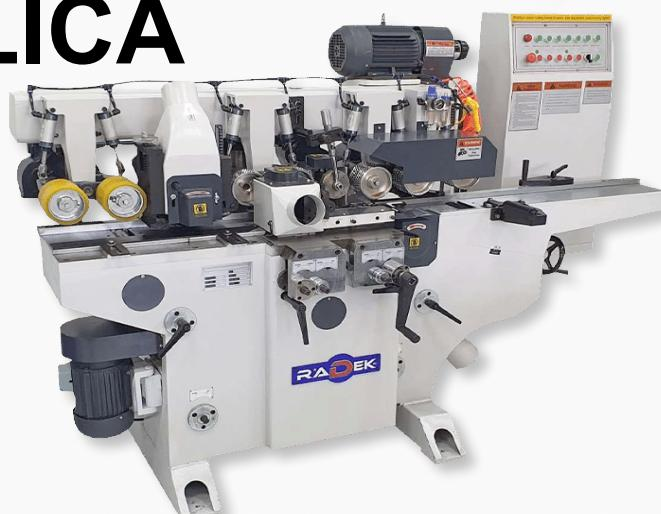
Dizajnirana za četverostranu obradu radnog komada. Najčešće se koristi za precizno ravnjanje, žlebovanje ili izradu oblika po vašem izboru brzinom do 20 metara u minuti. Tri stvari koje je čine odličnim izborom su kompaktne dimenzije jer zauzima malo prostora, ekonomična potrošnja i jednostavnost korišćenja i održavanja. Uz mašinu dolaze 4 glave na koje možete postaviti noževe (pločice) u obliku po želji.
