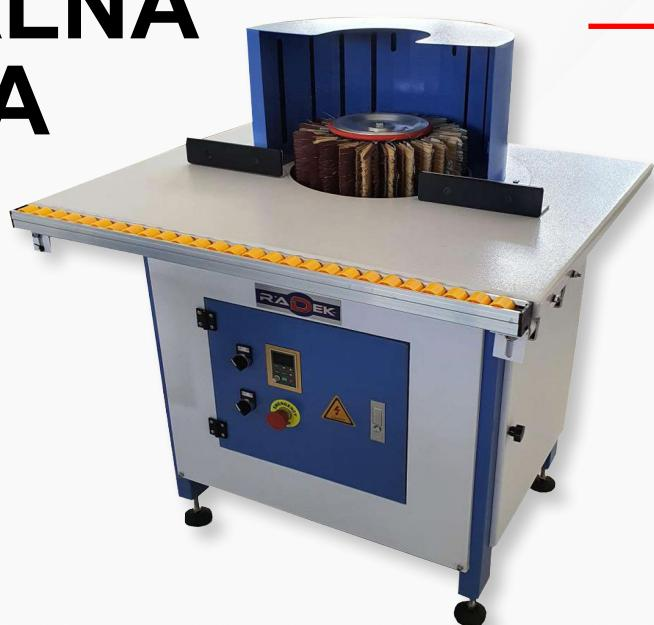
Dizajnirana za obradu punog drveta različitih oblika i pločastog materijala, najčešće medijapanata. Opremljena je sa dva motora, jednim za valjak brusne trake i drugim za oscilacije, što značajno poboljšava kvalitet brušenja. Na radnom stolu su postavljena dva graničnika koji se mogu podešiti prema pritisku obrade koji nam je potreban.
