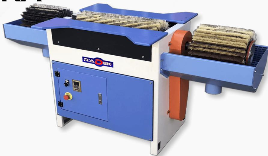
Dizajnirana za obradu punog drveta različitih oblika i pločastog materijala, najčešće medijapanu. Opremljena je sa tri valjka, od kojih su dva 300mm i jedan 600mm, koji omogućavaju da istovremeno rade dve osobe. Na srednjem valjku su postavljeni pomoći stolovi na kojima se postavlja i pomera radni komad.
