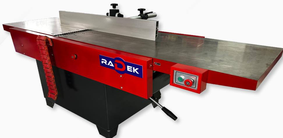
Industrijski abrihter RADEK premium serije sa spiralnom osovom koja garantuje vrhunsku glatku završnu obradu za razliku od standardnih tipova osovina. Dodatne prednosti spiralne osovine su lako promenljive pločice (noževi) koje se koriste sa 4 strane, mnogo tiši i stabilniji rad, prilikom oštećenja sečiva potreбno je zameniti samo jednu pločicu (oштети), mnogo bolja funkcionalnost kada je reč o čvorovima u drvetu i drugo...
