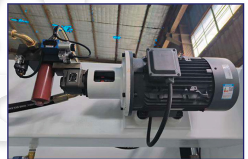
SIEMENS Main motor
